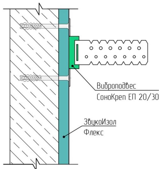
Нормативная нагрузка на Виброподвес Сонокреп ЕП 20 составляет 12,5-16 кг, максимальная - 30 кг.
